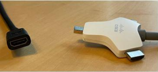
Afbeelding: Links de HDMI-contrastekker Rechts de Multihead-kabel
